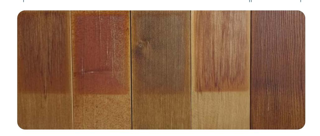
Plaques de bois exposées 2000 heures dans une enceinte de vieillissement UV. (Simule plusieurs années de vieillissement naturel, suivant les conditions climatiques)
